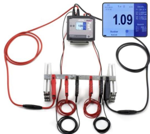
Anschluss und Messung mit PROMET SE
